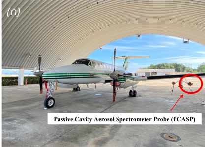
รูปที่ 1 (ก) เครื่อง Super King Air 350 ที่ใช้ปฏิบัติการวัดขนาดและความเข้มข้นของฝุ่นละออง และหัววัดอนุภาคฝุ่นขนาด 0.1-3 ไมครอน (ข) ลักษณะการพุ่งกระจายของฝุ่นละอองบริเวณกรุงเทพและปริมณฑล วันที่ 21 ธันวาคม 2567 เวลา 11:00 น.
